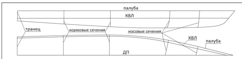
Рис. 3. Проекция кривых для построения поверхности обшивки
